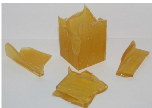
شکل ۳: شکست ترد نمونه و ایجاد لبه‌های تیز بر اثر گسترش ترک‌های محوری و جدا شدن تکه‌های بزرگ در حین فروپاشی.
