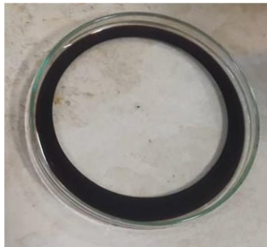
شکل ۱- نتیجه مثبت آزمایش پراکنش روغن توسط جدایه مخمری رشدیافته در محیط کشت بوشنل هاس پس از ۷۲ ساعت گرمخانه‌گذاری در دمای ۳۰-۲۸ درجه سانتی‌گراد تحت سرعت تکان دادن ۱۳۰ دور در دقیقه
