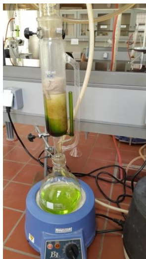
شکل ۱- عصاره‌گیری به روش سوکسیله
