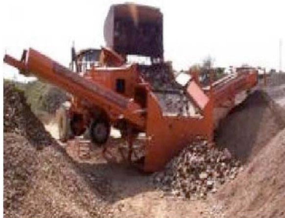
شکل ۴- نمونه‌ای از غربال اولیه قابل حمل مورد استفاده در پاکستان (۷)
