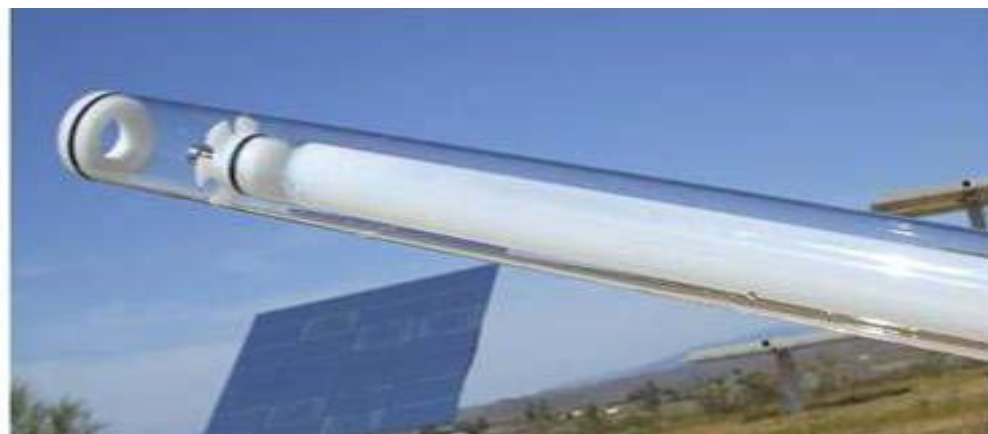
شکل ۲- طرح پایلوت دستگاه گندزدای فتوکاتالیز خورشیدی (۸)
