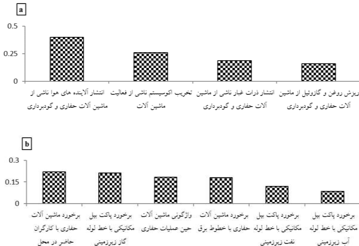
شکل ۱- نتیجه اولویت‌بندی ریسک‌های زیست محیطی (a) و فنی (b) در فرآیند حفاری و گودبرداری در پروژه احداث تصفیه خانه غرب اهواز
