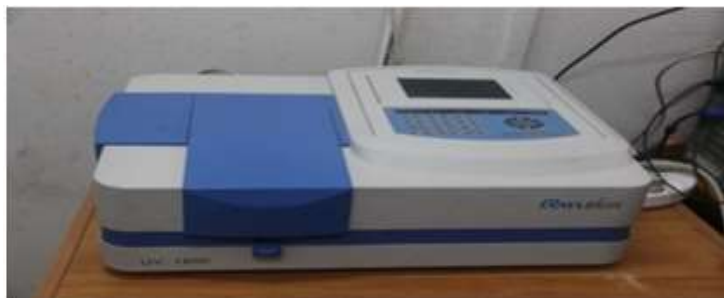
شکل ۱- دستگاه اسپکتروفوتومتر برای اندازه‌گیری COD
