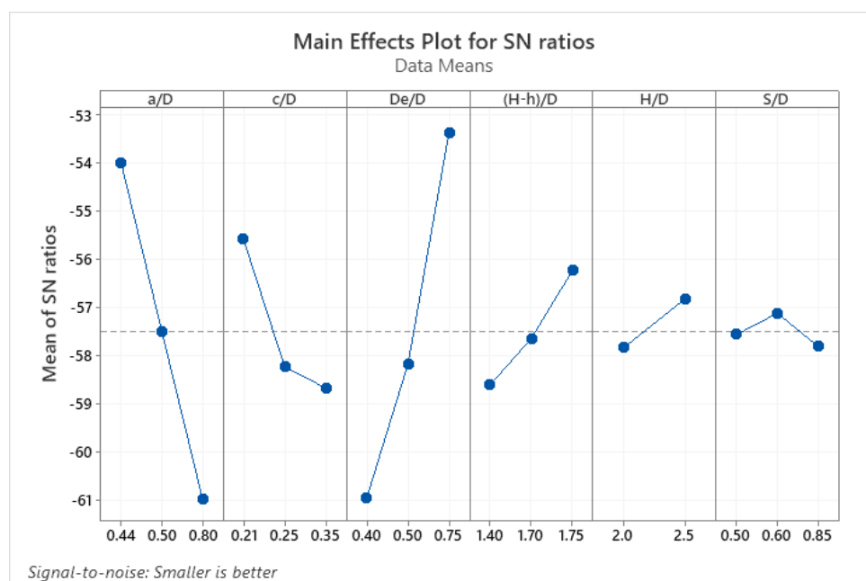
شکل ۷ - مقادیر سیگنال به نویز بر مبنای معیار کمتر بهتر برای افت فشار
