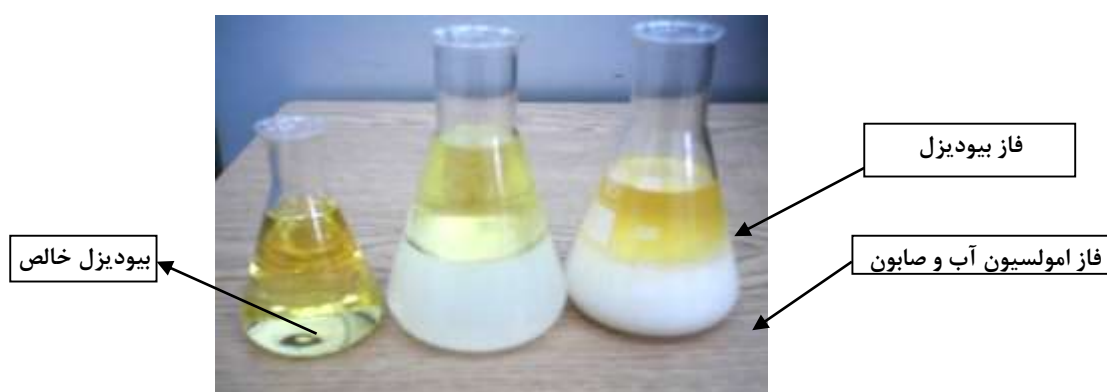
شکل ۴- مراحل انجام واکنش تولید بیودیزل الف) مخلوط واکنش قبل از شروع واکنش ترانس استریفیکاسیون ب)
