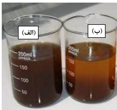
شکل ۱- روغن پسماند خوراکی الف) قبل و ب) بعد از مرحله پیش‌فرآوری
