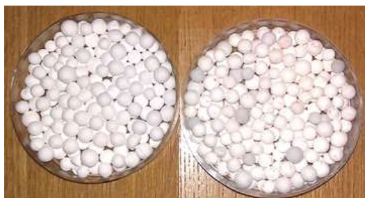
شکل ۱- تصویر کاتالیست های احیا شده (راست) و کاتالیست تازه (چپ)
