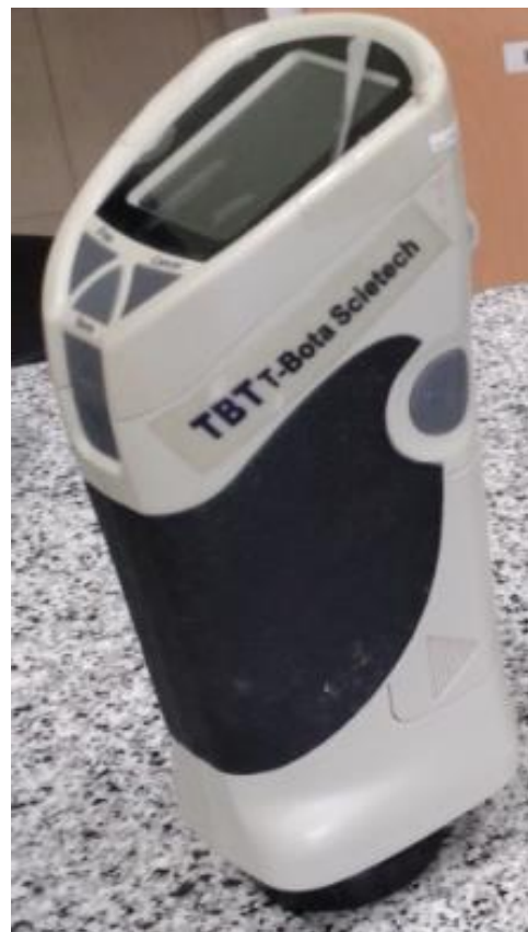
Figure 2- Colorimeter used in the experiment شکل ۲- دستگاه رنگ‌سنج مورد استفاده در آزمایش
