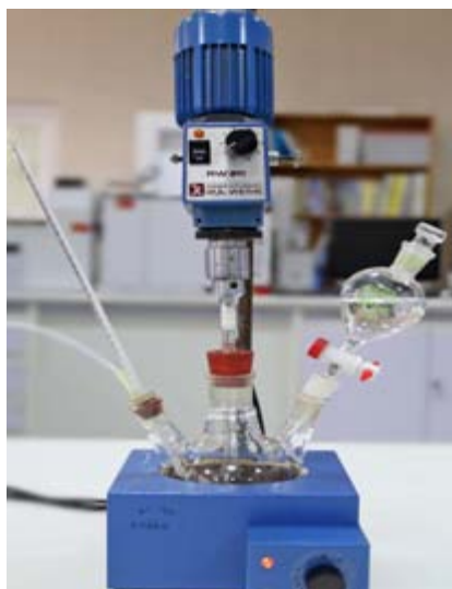
شکل ۲- سیستم مورد استفاده برای سنتز نانوذرات مغناطیسی
