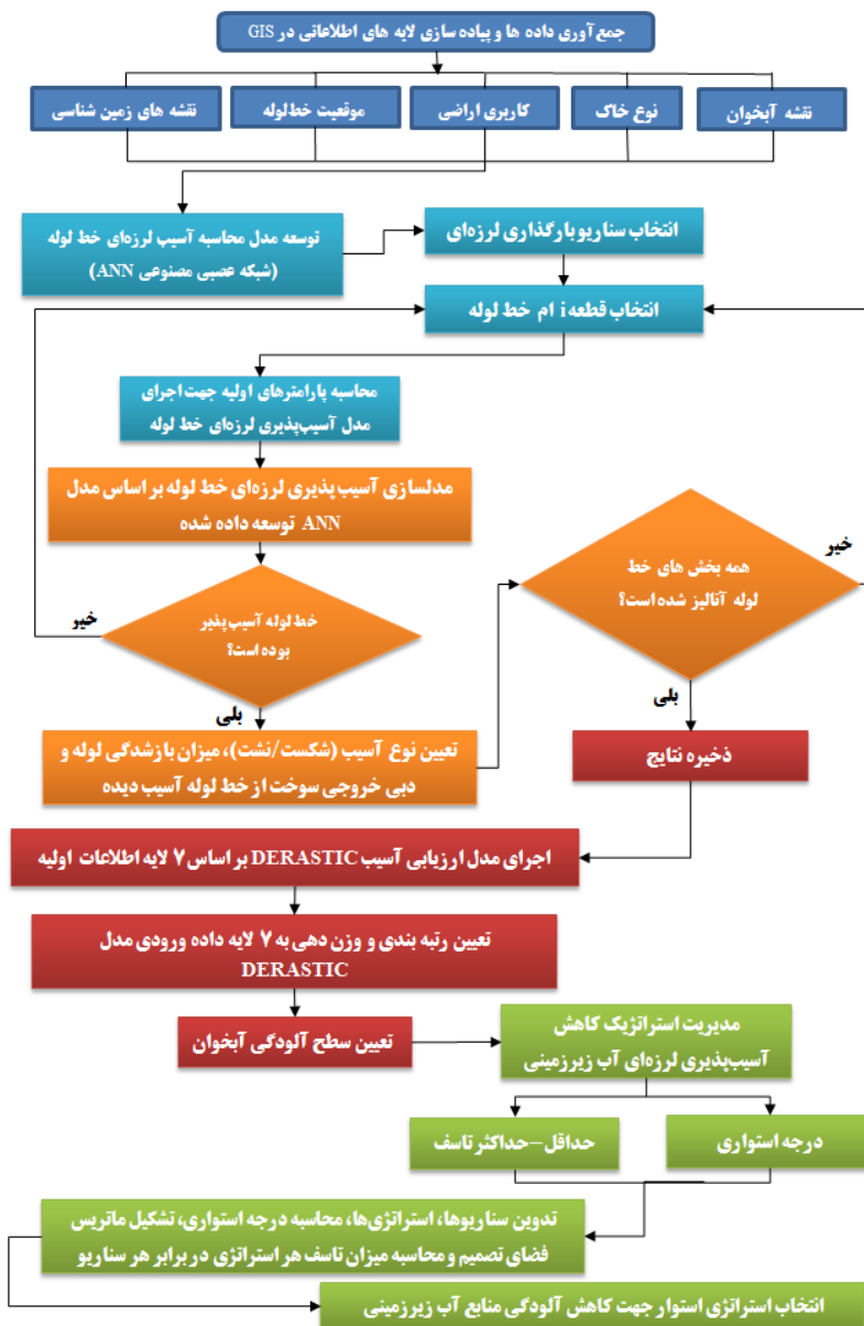
شکل ۲. روندنمای فرآیند محاسبات مدل شبکه عصبی مصنوعی و دراستیک
