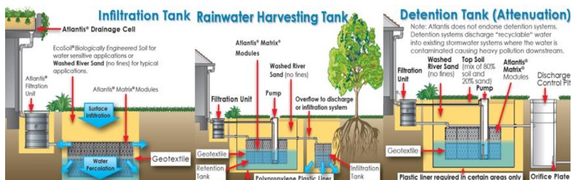
شکل ۲: موقعیت مخازن ذخیره‌سازی و استفاده مجدد از آب باران؛ مأخذ: شرکت آتلانتیس، ۲۰۱۴
