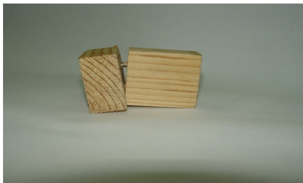
شکل ۹. نحوه شکست و جدایی در اتصال پیچ در بررسی مقاومت گشتاور خمشی
