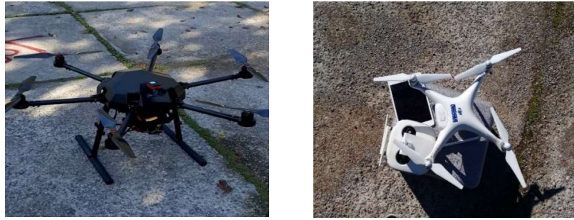
شکل ۲. پهپاد Phantom 4 pro (راست) و پهپاد Storm 2 (چپ)
