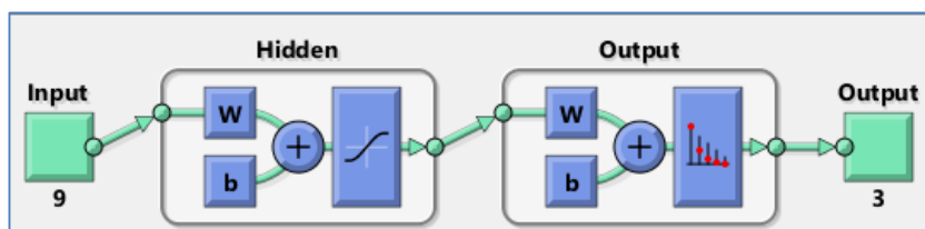
شکل ۳: ساختار شبکه عصبی در دستور patternnet
