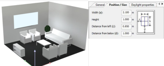
شکل ۱۰. محاسبه ابعاد مناسب پنجره هال و پذیرایی با در نظر گرفتن متوسط نور روز مناسب ( DF=1.5\% ) برای این کاربری. ابعاد پنجره، برابر 2/10 متر مربع به دست آمده است. این اندازه برابر 2/84\% کل سطوح داخلی اتاق و 20\% چداره نورگیر می باشد.
