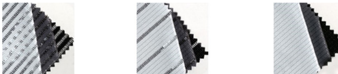
شکل ۱. به ترتیب از راست به چپ: پرده غلتکی انعکاسی با تراکم بالا، پرده غلتکی انعکاسی با تراکم متوسط، پرده غلتکی معمولی با تراکم پایین (Source: ludvigsvensson, 2015)
