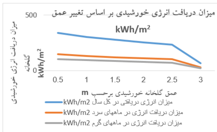
شکل ۹. میزان دریافت انرژی خورشیدی بر اساس تغییر عمق گلخانه فورشیدی Figure 9. The amount of solar energy received based on the changes in the depth of the Sunspace
