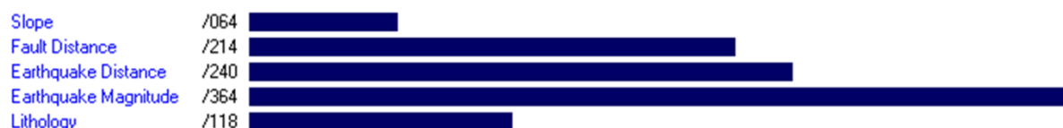
شکل ۸: نمودار وزن محاسبه شده معیارها با استفاده از نرم افزار Expert Choice
