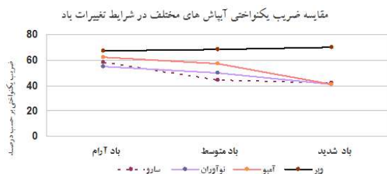
شکل ۱۰- مقایسه ضریب یکنواختی آبیاش‌های مختلف در شرایط تغییرات سرعت باد
