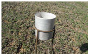
شکل ۶- قوطی و سه پایه مورد استفاده جهت جمع آوری آب خروجی از آبپاش
