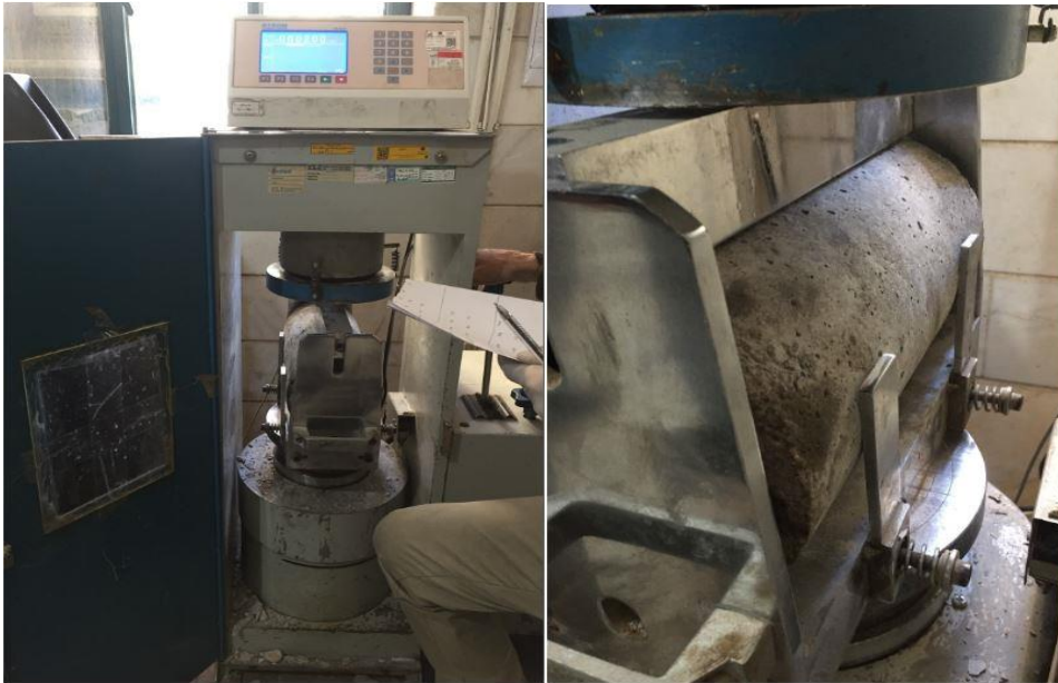
شکل ۶- دستگاه آزمایش مقاومت کششی نمونه استوانه ای (برزیلی)
