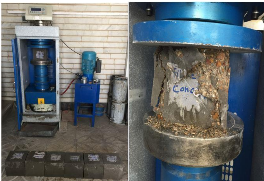
شکل ۵- آزمایش مقاومت فشاری نمونه‌های مکعبی
