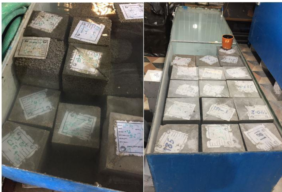
شکل ۴- عمل آوری و نگهداری نمونه های بتنی در داخل حوضچه های آب در دمای آزمایشگاهی
