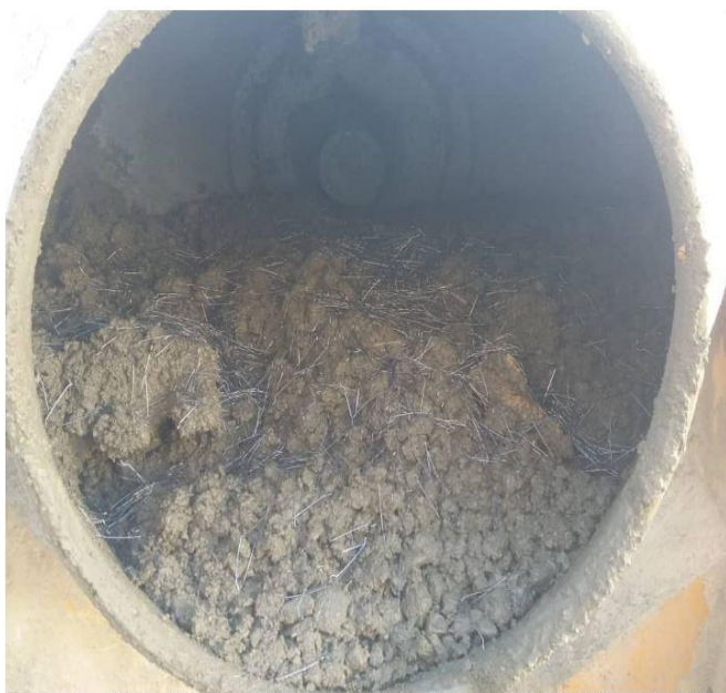
شکل ۲- اضافه کردن الیاف فولادی به بتن در حین اختلاط بتن در دستگاه بتو نیر
