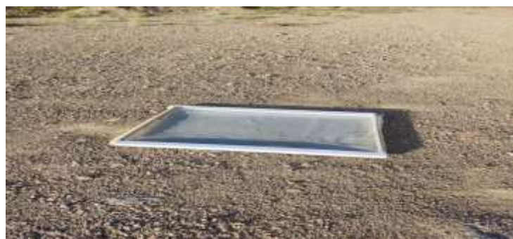
شکل ۳- تله رسوب گیر نصب شده در نقاط نمونه برداری
