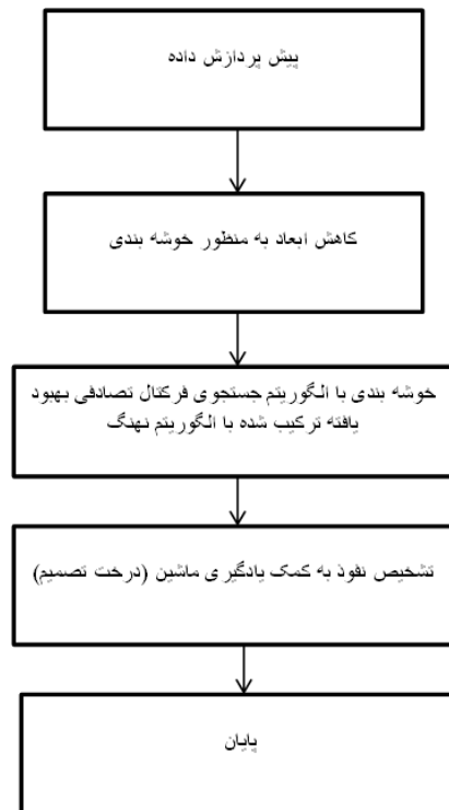
شکل ۲: فلوچارت سیستم تشخیص نفوذ پیشنهادی
