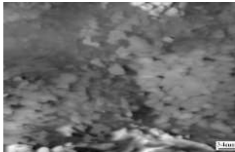
شکل ۲- تصویر دو بعدی نانواکسید روی با میکروسکوپ STM
