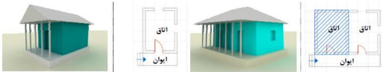
تصویر ۲ الگوی ساخت بعد از زلزله، سمت چپ هسته اولیه بازسازی، سمت راست گسترش بعدی توسط ساکنان. مأخذ: (Fayazi, 2011)
