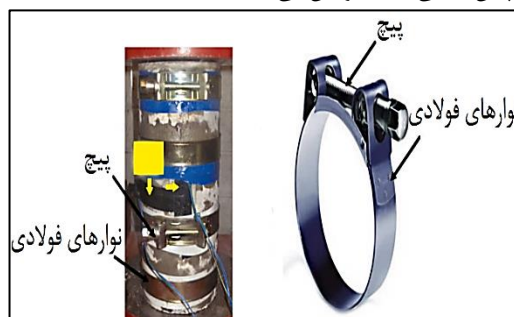
شکل ۶ - اعمال پیش تنیدگی حلقه با استفاده از گیره نواری فولادی [۱۶].
