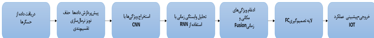
شکل ۱-فلوچارت مراحل پیش پردازش و اجرای الگوریتم CNN-RNN روی دستگاه های IoT
