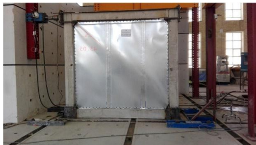
شکل 9: تشکیل میدان کشش قطری نمونه ورق گالوانیزه
