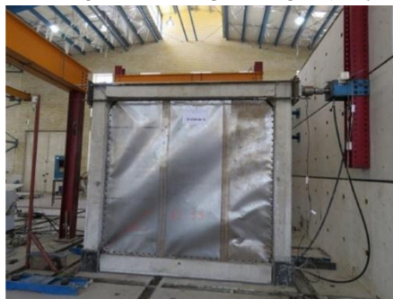
شکل 7: تشکیل میدان کششی قطری در نمونه ورق سیاه
