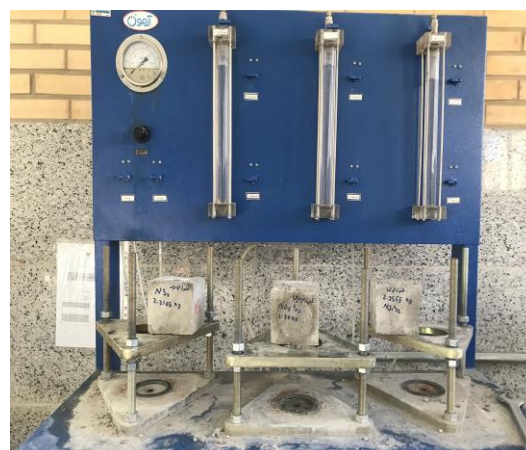
شکل ۴: دستگاه اندازه گیری نفوذپذیری آب.
