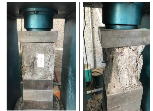
شکل ۸: تصویر نمونه پس از اعمال بار در تست مقاومت فشاری.
