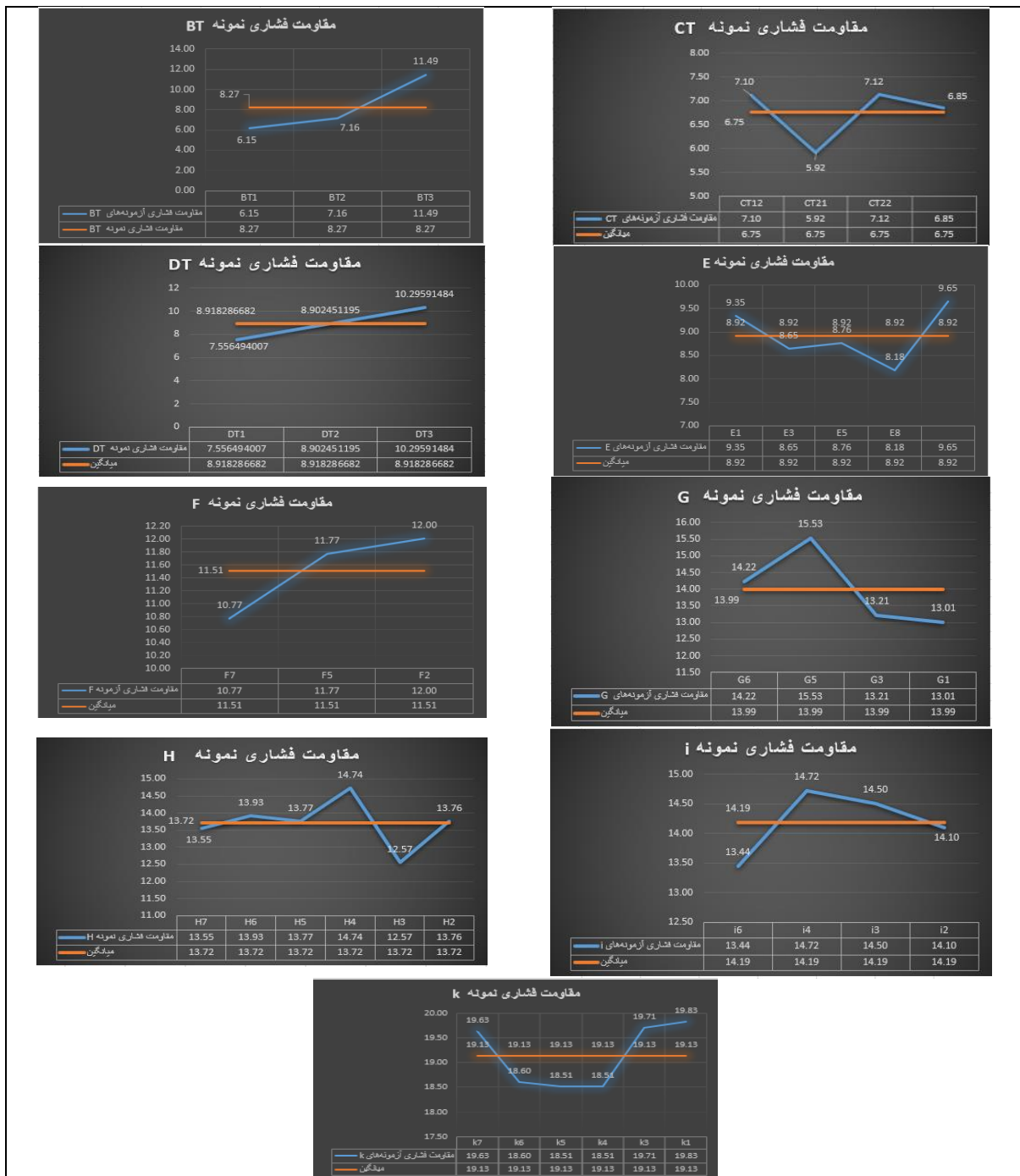
شکل 7: نمودار مقادیر تنش آزمونه‌های هر نمونه
