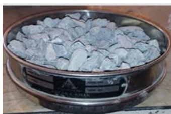
رنج D و سائز مابین قطر 12.5 و 16 میلی متر
