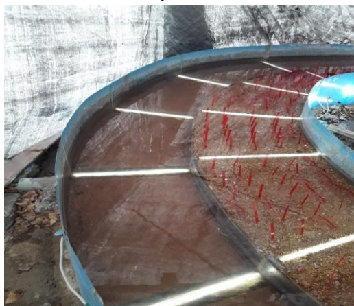
شکل ۵- تصویر انتشار ماده ردیاب در حالت پوشش گیاهی پنج ردیفه سیلابدشت
