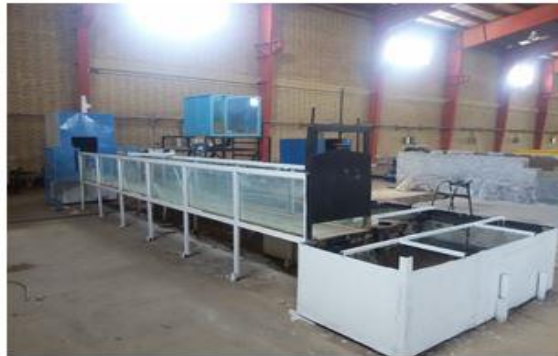
شکل ۲- سرریز و فلوم آزمایشگاهی مورد استفاده در تحقیق حاضر
