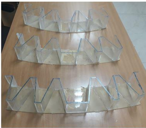
شکل ۳- نمایی از سرریز زیگزاکی قوسی ذوزنقه‌ای
