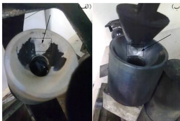
شکل ۶- تصاویر ماکروسکوپی از وضعیت نمونه‌ها پس از قرارگیری در معرض شار حرارتی (محل شاردهی با کادر مشخص شده است)، (الف) نمونه پوشش داده شده و (ب) نمونه بدون پوشش
