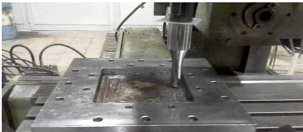
شکل ۶ - شکل گیری نمونه هرمی در حین فرآیند
