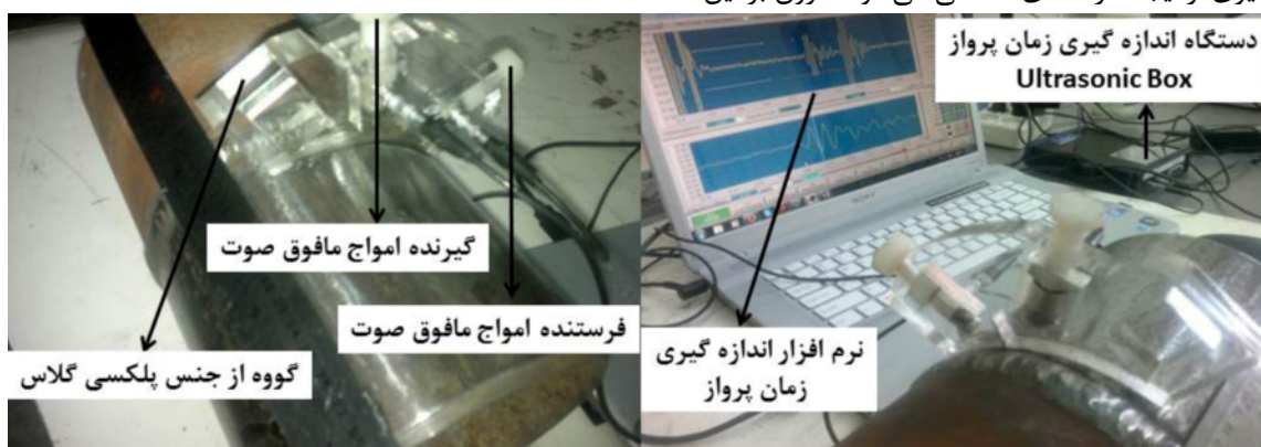
شکل ۶- تجهیزات و سامانه مورد استفاده در تحلیل تنش پسماند.
