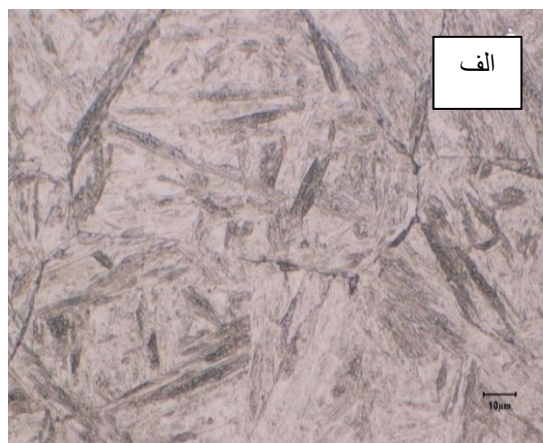
شکل ۶- تصویر میکروسکوپ نوری فولاد زنگ نزن مارتنزیتی AISI 422 ثابت‌های: (دمای آستنیت‌دهی: ۱۰۴۰°C ، زمان نگهداری ۱۵ دقیقه، نرخ گرمایش 3/4^{\circ}C/s ) متغیر: (مدت زمان سرد کردن الف: ۲۴ ساعت ب: ۴۸ ساعت).
