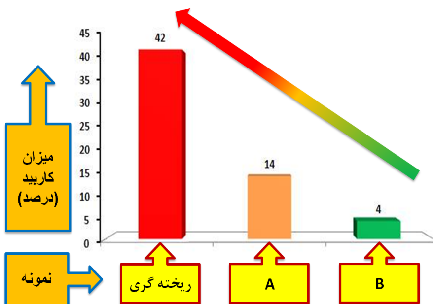
شکل ۴- تعیین توزیع کاربید در نمونه های مختلف توسط نرم افزار Image J
