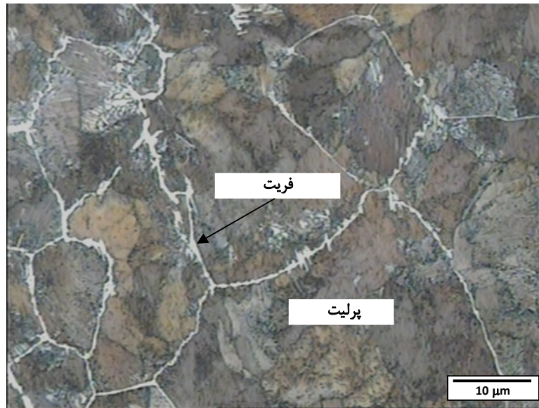
شکل ۶- تصویر میکروسکوپ نوری نمونه C در ناحیه براده فولادی.
