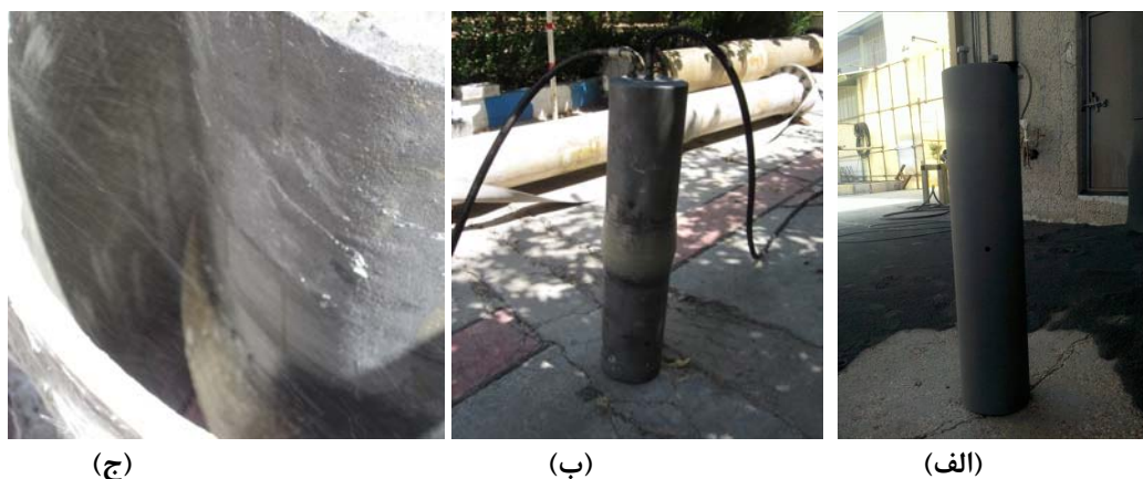
شکل ۱- (الف) لوله آماده شده برای هیدروتست، (ب) لوله لایه‌زنی شده و چگونگی قرارگیری آن برای هیدروتست، (ج) مشاهده نشتی پس از انجام هیدروتست روی نمونه
