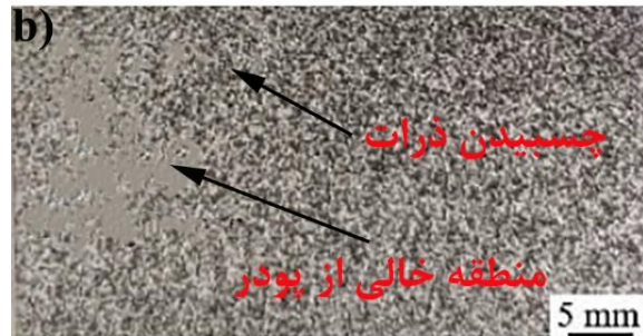
شکل ۴- سطح ورق آلومینیوم (a) پس از برس کاری با سیس و (b) پس از پاشش پودرهای WC-MoS 2
