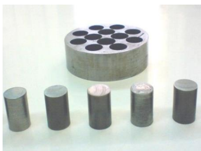
شکل ۱- نمونه‌های آماده شده قبل از آزمون فشار گرم
