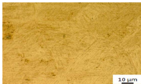
شکل ۸- ریزساختار نمونه‌های آزمون فشار گرم تحت دمای پیشگرم ثابت 1200^{\circ}C در نرخ کرنش‌های
