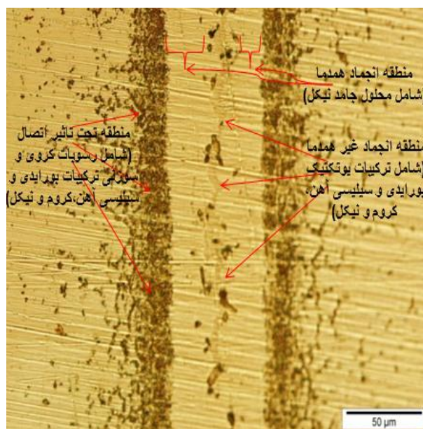
شکل ۱- تصویر میکروسکپ نوری اتصال فاز مایع گذرا با لایه واسط MBF-20 در دمای 1050^{\circ}C و زمان ۴۵ دقیقه
