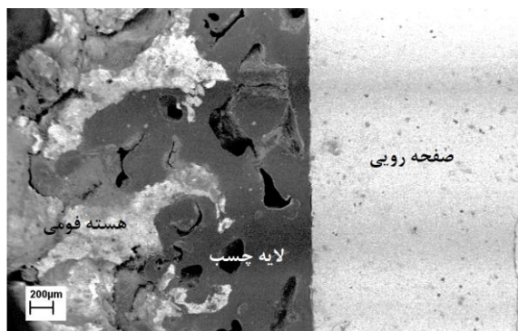
شکل ۶- تصویر میکروسکوپ الکترونی روبشی از فوم شدن چسب M در داخل حفرات هسته فومی و قفل شدن و پیوستگی مطلوب اتصال
