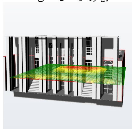
شکل ۱۲- دیاگرام آنالیز نور روی کف فضای داخلی خانه در مدل سه بعدی کل خانه، خروجی نرم افزار راینو پلاگین دیوا
