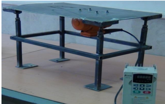
شکل (۲) ویبراتور مکانیکی به همراه ارتعاش سنج
