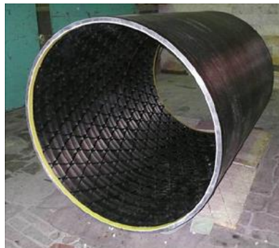
شکل (۲): (الف) ریب‌ها و پوسته در سازه‌های کامپوزیتی (ب) سازه کامپوزیتی [۸].
