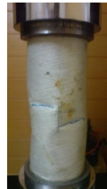
شکل (۶): نمونه ساخته شده تحت بار محوری به همراه مدل اجزاء محدود آن.
