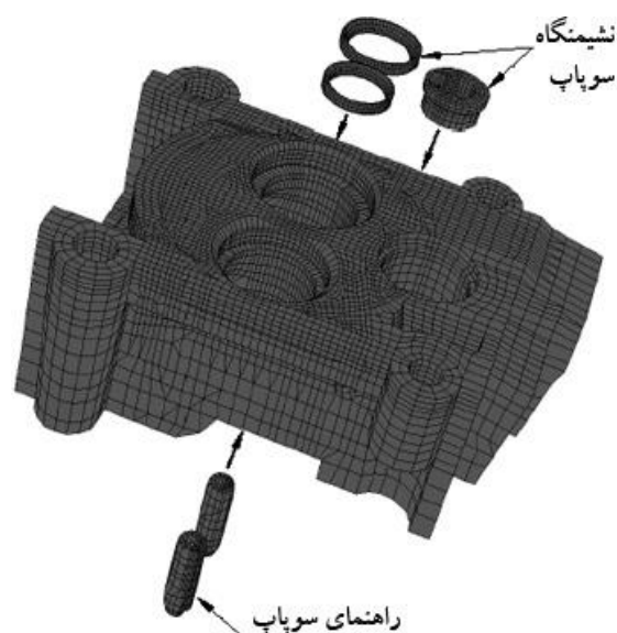
شکل (۴) اجزای سرسیلندر [۳۸].
