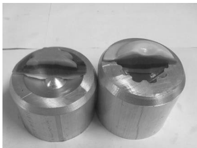
شکل (۸) شماتیکی از مدل برش خورده چرخ‌دنده مخروطی با لایه‌های رنگی متفاوت خمیر مجسمه‌سازی.
