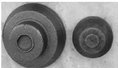
شکل (۱۲) پیش‌فرم خام چرخ‌دنده‌ها به روش آهنگری مرسوم جهت عملیات ماشینکاری.
