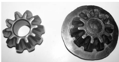
شکل (۱۱) چرخ‌دنده‌های تولید شده به روش آهنگری سرد دورانی.
